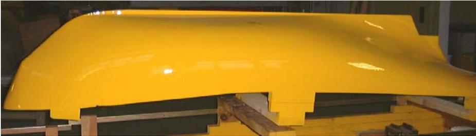
Fig. 12 Modelo del buque VAL construido en INSEAN.
