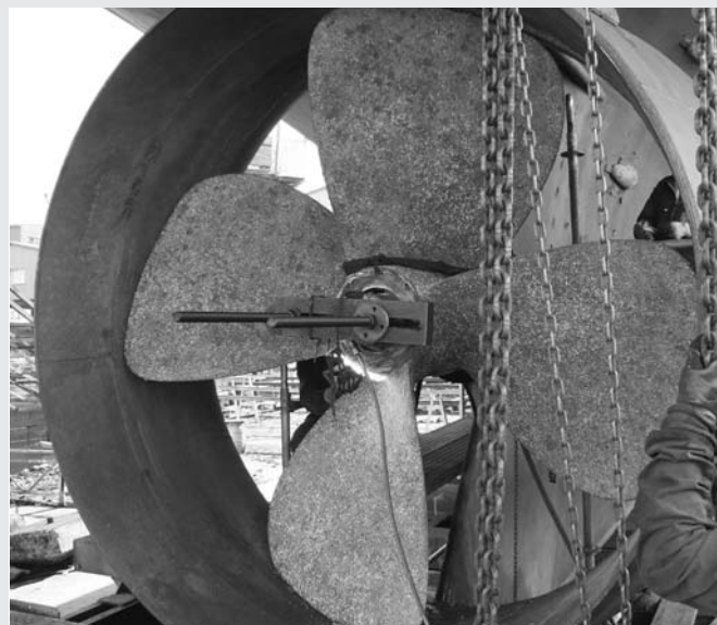
Fig. 9 La hélice del I/LA antes de la limpieza y durante desmontaje.
