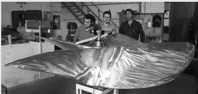
Fig. 10 Hélice del ILA después de limpieza y durante medición en Fundilusa
