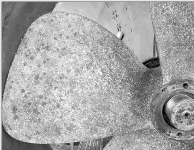
Fig. 5 Fouling en el propulsor de uno de los buques de estudio en el proyecto.
