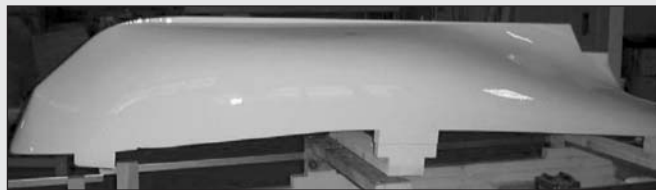
Fig. 12 Modelo del buque VAL construido en INSEAN
