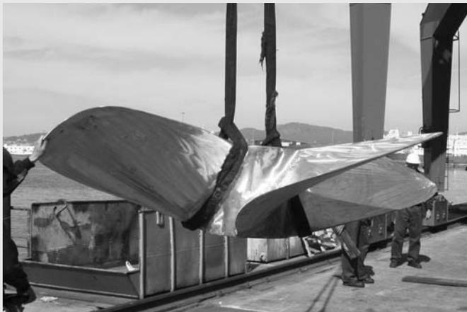
Fig. 10: Hélice ya limpia durante su montaje
