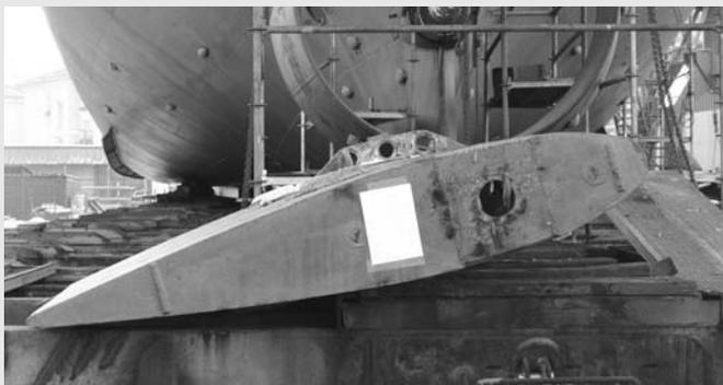
Fig. 6: Aspecto de la sección del timón ya desmontado
