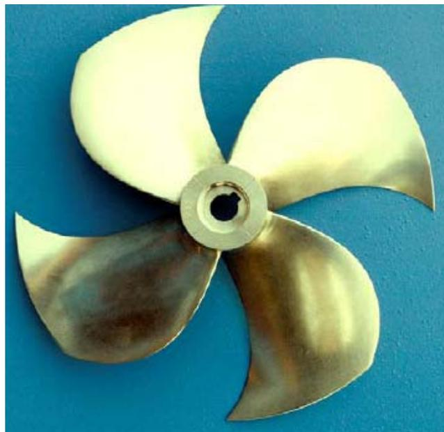
Figura 29. Modelo de la hélice para el buque “VAL”
