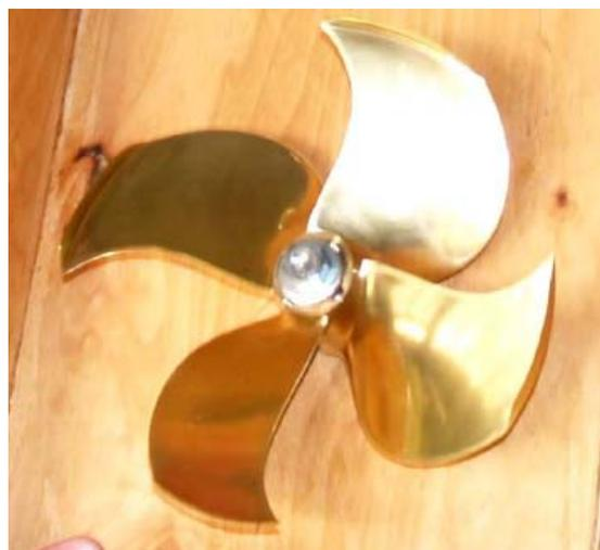
Figura 27.- Modelo de la hélice CLT para el buque “ILA”
